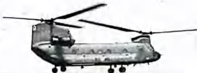
图 1.62 波音 CH-47 “支奴干”，双旋翼纵列式直升机
