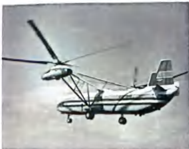
图 1.63 米-12 直升机, 双旋翼横列式直升机
