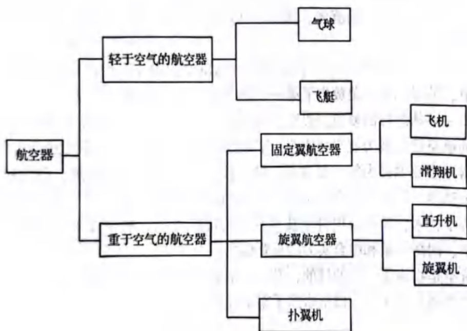
图 1.1 航空器的机械构造分类
